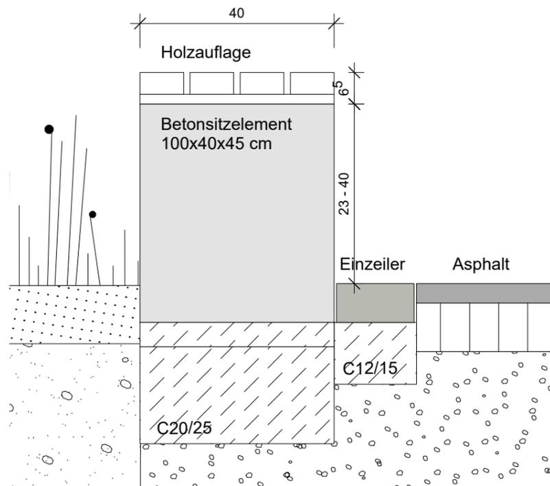
Schemaschnitt Sitzelement mit Holzauflage, M 1:10
